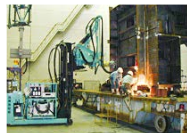
450Kvp可搬式にて橋梁ブロックを撮影
